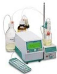
Кулонометрический титратор 831 KF Coulometer является экономичным прибором для определения влаги в диапазоне от 0,001 до 1%. Несмотря на компактность и простоту, прибор обладает рядом существенных достоинств.
