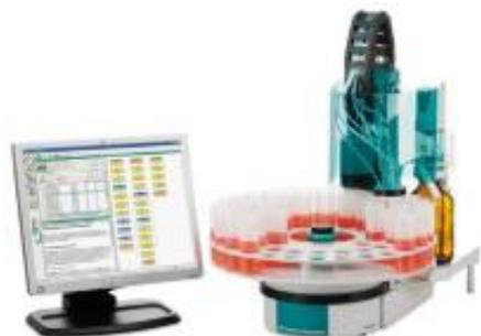
2.855.1020 - **Robotic Acid-Base Analyzer** - готовый комплект для кислотно-основного титрования (до 59 образцов). В комплекте: пропеллерная мешалка, система дозирования Dosino, электрод для кислотно-основного водного титрования, специальное ПО для титрования, а также другие необходимые комплектующие.
