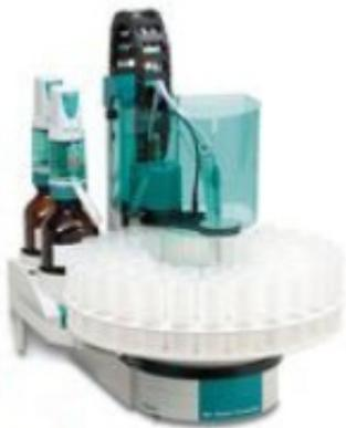
Роботизированный автоэмплер со встроенным титратором открывает новые возможности в автоматизированном потенциометрическом титровании. Благодаря этой комбинации около 40% рабочей поверхности обычно необходимой для автоматизированного титрования можно сэкономить. И все это возможно без потери функциональности и гибкости.
