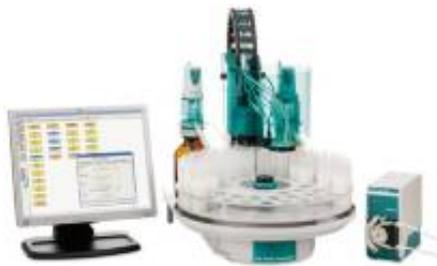
2.855.1010 - **Robotic Chloride Analyzer** - готовый комплект для автоматизированного анализа хлорид-ионов (до 59 образцов) с промывкой электрода и стаканчиков. В комплекте: дополнительный насос, пропеллерная мешалка, 2 системы дозирования Dosino, серебряный электрод, специальное ПО для титрования, а также другие необходимые комплектующие.
