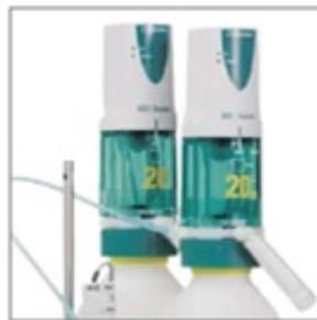
чип данных содержит всю необходимую для пользователя информацию: объем, серийный номер, название реактива, его концентрацию, титр, историю титра. Титратор автоматически считывает информацию при подключении к нему дозирующей бюретки.
