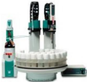
MATi 11 - полностью автоматическая система объемметрического титрования по Карлу Фишеру для определения воды в пробах (до 53 образцов). Система управляется с помощью специального программного обеспечения **tiamo™** и состоит из автосэмплера 815 USB Sample Processor XL, **автоматического титратора 901 Titrando**, гомогенизатора **Polytron**, а также других необходимых комплектующих.
