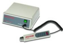
Гомогенизатор Polytron PT 1300 D версии Metrohm разработан специально для пробоподготовки образцов для титрования по Карлу Фишеру. С помощью PT 1300 D можно измельчить пробу прямо в ячейке титрования. По причине того, что пробоподготовка выполняется непосредственно в ячейке титрования, устраняется возможность изменения содержания влаги в образце при его размельчении и переносе в ячейку (в случае использования обычного гомогенизатора).
