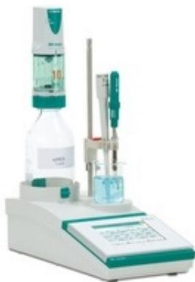
Новый уникальный компактный титратор от Metrohm предлагает максимальное количество возможностей среди автономных титраторов. Титратор 916 Ti-Touch в одном устройстве объединяет бюретку, мешалку, дозирующую систему и сенсорную панель Touch Control. Прибор поставляется полностью укомплектованным (дозировочная система, бюретка, пропеллерная мешалка, встроенная сенсорная панель и различные электроды) в трех вариантах:
