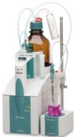
Титратор 888 Titrando является универсальным прибором для потенциометрического титрования. Прибор уже полностью укомплектован необходимыми аксессуарами и готов к работе, нужно только подобрать подходящие электроды. Несмотря на то, что автоматический титратор 888 Titrando является самым простым и экономичным в линейке титраторов Titrando, он обладает широкими возможностями и может решить почти любую задачу потенциометрического титрования:
