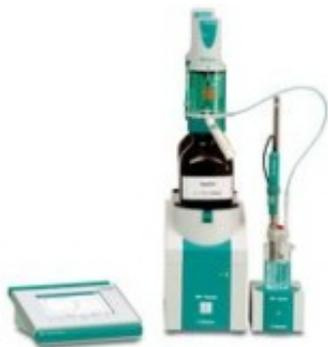
Автоматический титратор 905 Titrandо может решить любую задачу автоматического потенциометрического титрования:
