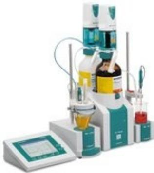
Укомплектованный титратор Pharm Titrandо на базе автоматического титратора 907 Titrandо был разработан для решения наиболее распространенных задач по анализу фармацевтических продуктов.
