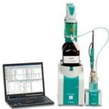
Укомплектованный титратор Surf Titrando для анализа ПАВ на базе [автоматического титратора 905 Titrando](#) был разработан для решения наиболее распространенных задач по анализу поверхностно-активных веществ (в том числе для двухфазного титрования).
