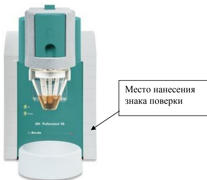
Рисунок 1 - Общий вид анализатора вольтамперометрического 884 Professional VA/CVS
