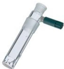
Индикаторные и генераторные электроды для определения влаги объемметрически и кулонометрически по Карлу Фишеру.
