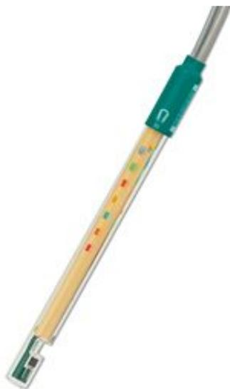
В случае, если потенциометрическое определение конечной точки не возможно, но при этом требуется удобный, простой и недорогой (в сравнении с ААС или ИСП-АЭС методами) способ анализа, то автоматический титратор с датчиком Optrode будет лучшим выбором.
