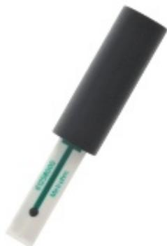
Вольтамперометрия с использованием scTRACE Gold предлагает простую и доступную альтернативу спектроскопическому определению мышьяка. Электрод позволяет просто и достоверно проводить анализ мышьяка в питьевой воде с предельным значением 10 мкг/л. На самом деле предел обнаружения с использованием scTRACE Gold значительно меньше! Время анализа образцы около 10 минут.
